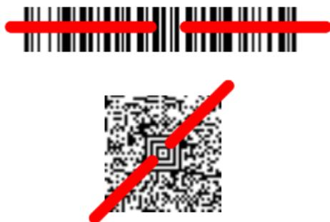
Maintenez le lecteur sur le code à barres, appuyez sur la gâchette et centrez le faisceau de visée sur le code à barres.
